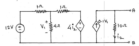
D) Find the Y parameter and Z parameter for the given network
